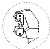
Outil d'enfoncement de la goupille sur le collier du cylindre modulaire
